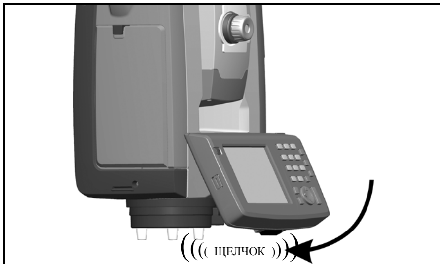
Рис. 4.38. Установка контроллера Trimble CU
