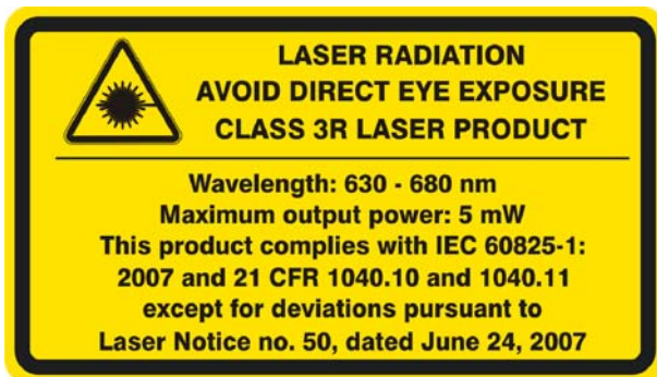
Рис. 3.25. Наклейка предупреждения о лазерном указателе с дополнительной функцией высокой мощности
