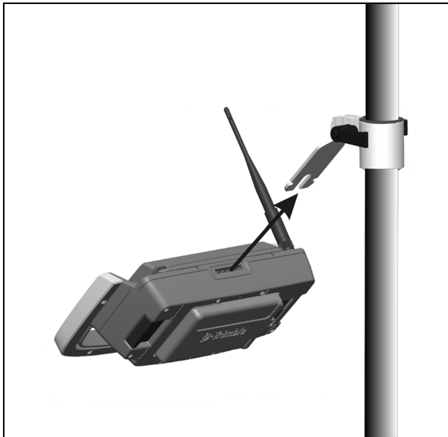
Рис. 7.74. Установка держателя Trimble Robotic на адаптер стандартной вежи
