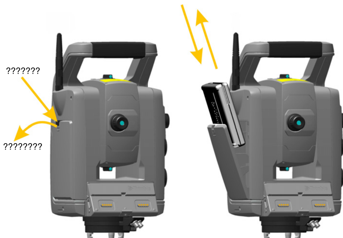
Рисунок 3.7. Установка и извлечение внутренней батареи
