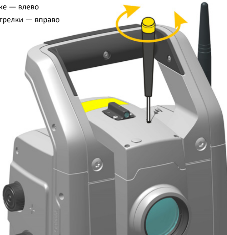
Рисунок 4.7. Юстировка положения лазерного указателя по горизонтали
