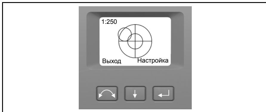
Рис. 3.18. Окно электронного горизонтирования на дисплее круга 2
