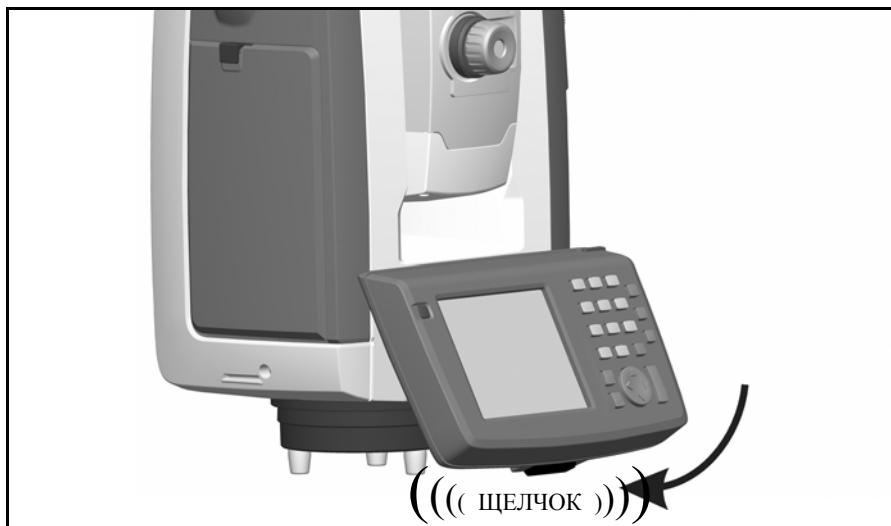
Рис. 4.40. Установка контроллера Trimble CU
