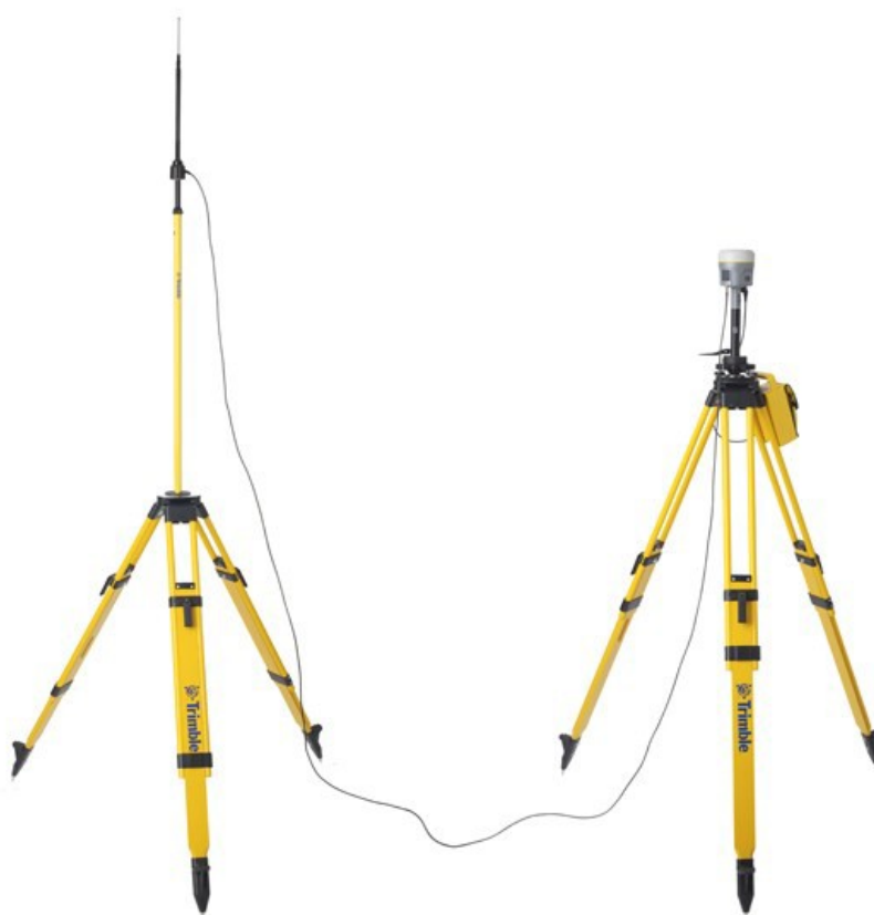
Присоединение кабеля внешней антенны к приемнику
