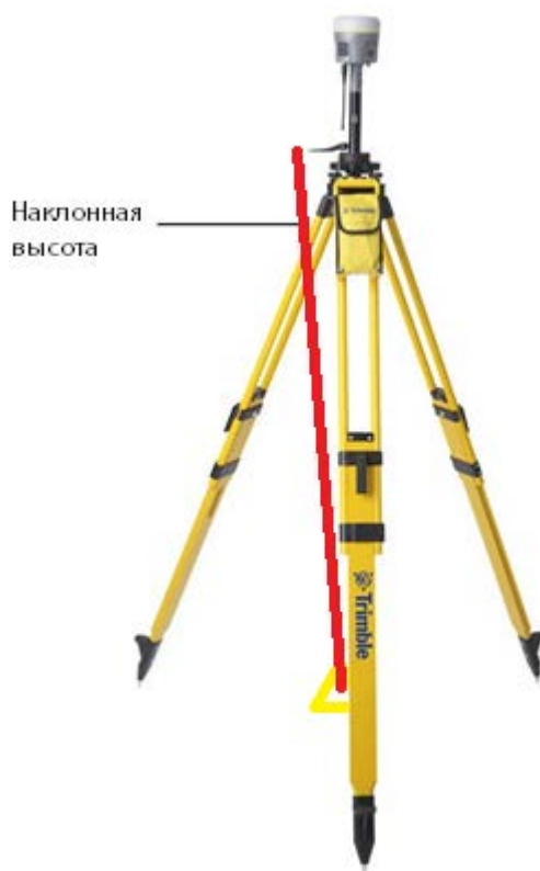
Установка приемника с внутренним УКВ радио на штативе (измерена наклонная высота)
