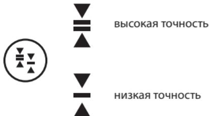
Для того, чтобы узнать, в каком режиме точности находится приемник, посмотрите на индикатор на ЖК-дисплее. Точность определения лазерного луча изменяется при нажатии на кнопку «настройка точности». При включении приемника по умолчанию выставляется высокая точность обнаружения положения лазерного луча.
