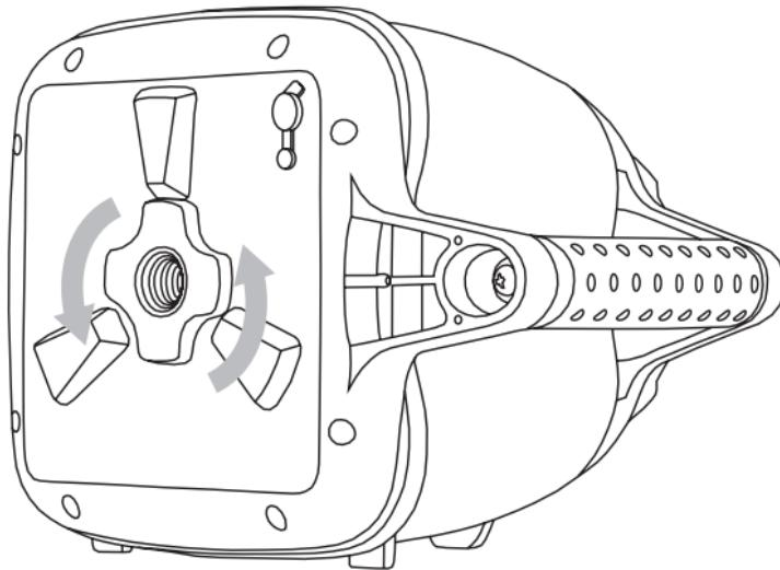
Питание RGK SP-310 осуществляется от четырёх батареек Ni-MH, а также аккумуляторов, входящих в комплект устройства. Мигание светодиода под кнопкой ① означает низкий заряд батареи прибора. Рекомендуется заменить батарею во избежание её повреждения.
