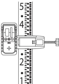
При поиске отметки ослабьте винт крепления и плавно перемещайте адаптер с приемником вверх-вниз по рейке до обнаружения исходной точки.
