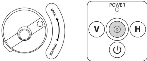
Клавиша Н управляет включением/отключением горизонтальной линии. Клавиша V отвечает за включение/выключение вертикальной линии, повторное нажатие включает вторую (у LP-62), третью и четвертую (у LP-64) вертикали. Лазерный отвес включается при нажатии кнопки V. Переключение тумблера в позицию Lock блокирует компенсатор и позволяет работать с наклонными плоскостями.
