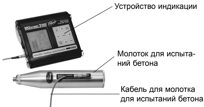
Рис. 2.1 Устройство индикации и молоток для испытательного бетона (Модель ND/LD)
