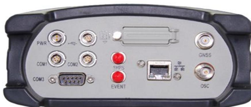
Рисунок 4 – Общий вид аппаратуры E-Survey Net20 Plus со стороны задней панели
