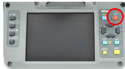
*Примечание. Проверьте правильность установки батарей в отсеке, если прикладная программа не запускается даже после нажатия кнопки [Power].*
