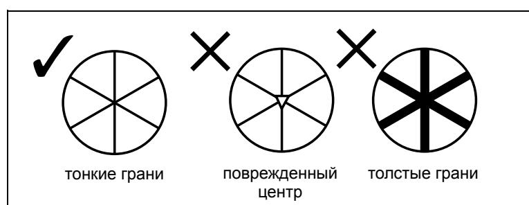
Так как тахеометр серии Nivo очень чувствительный, многократные отражения от поверхности призмы иногда могут стать причиной значительного ухудшения точности.
