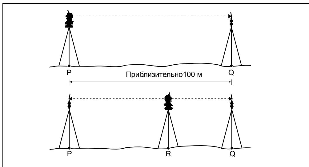
Для проверки постоянной инструмента:
