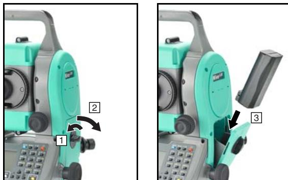
1. Поверните фиксатор батарейного отсека против часовой стрелки и откройте крышку батарейного отсека.
