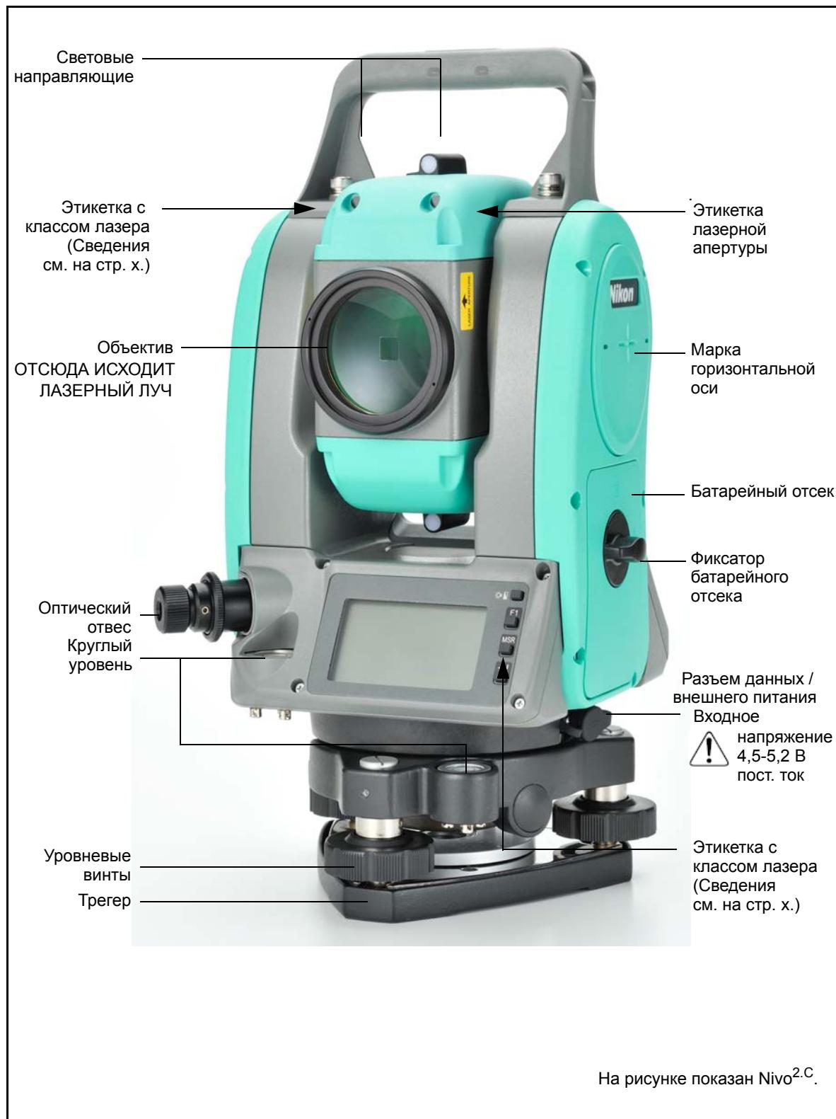
Рисунок 1.2 Электронный безотражательный тахеометр серии Nivo – Сторона-2
