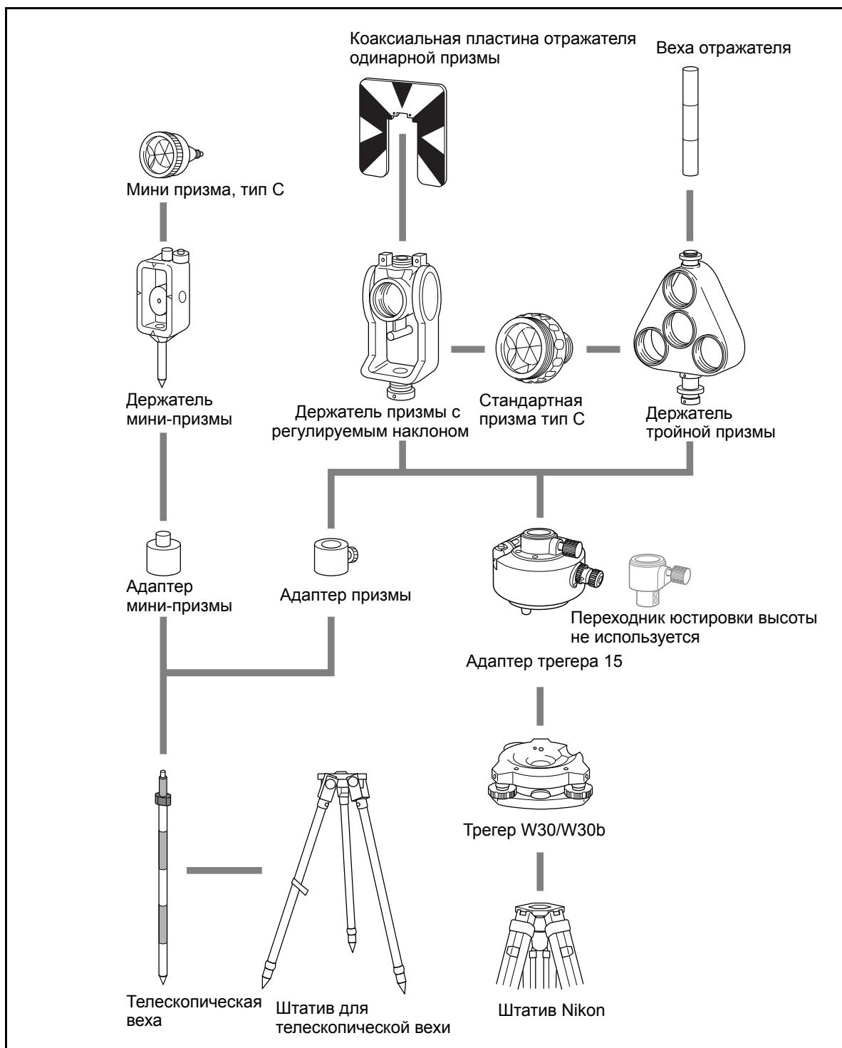
Рисунок 6.2 Компоненты призменного отражателя
