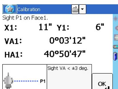
При наведении инструмента на цель, у которой значение VA превышает  $3^\circ$ , отобразится предупреждение, и кнопка [OK] будет отключена.
