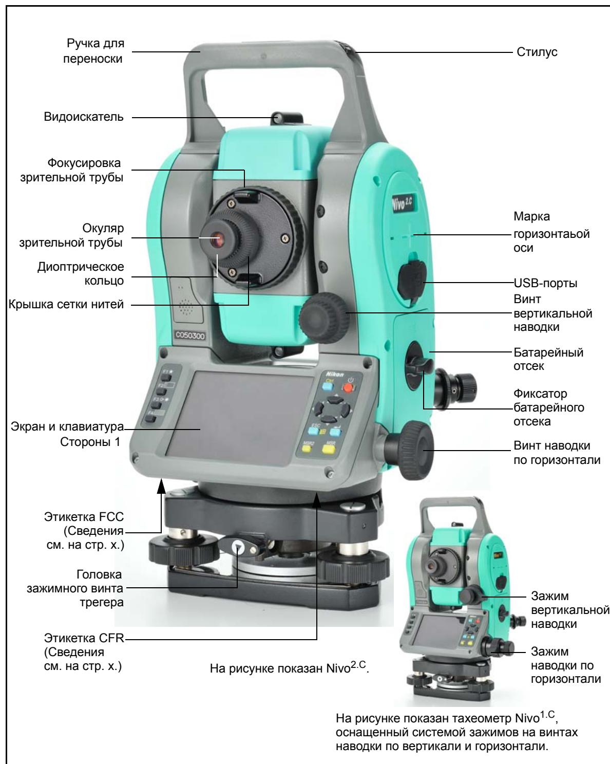
Рисунок 1.1 Электронный безотражательный тахеометр серии Nivo – Сторона-1
