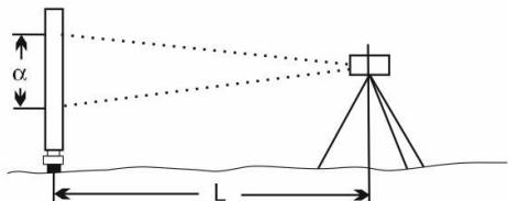
от центра инструмента до рейки. Снимите значение отрезка на рейке, между двумя дальномерными штрихами и умножьте это значение на 100, получаем значение расстояния L.
