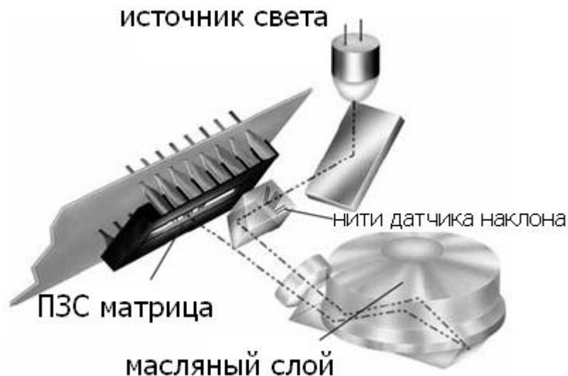
Рис. 6 Принцип работы двухосного датчика наклона (компенсатора)
