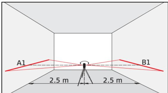
Установите прибор на штативе на равном расстоянии от двух стен (A+B), которые отстоят друг от друга примерно на 5 метров.
