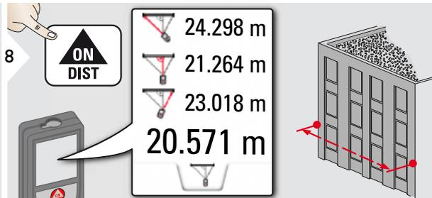
**i** Результат отображается в главной строке. Нажатие на клавишу измерения в течение 2 сек активирует автоматическое выполнение измерений минимального и максимального расстояния.
