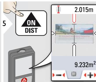
Выбрать стрелки с помощью курсорных клавиш, или нажав на сенсорный экран, и выберите нужные значения с помощью сенсорных клавиш. Рассчитана соответствующая площадь.
