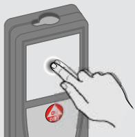
Нажмите на дисплей, чтобы открыть экранную кнопку или сделать выбор. Нажатие на значок посередине нижней линии активирует измерение расстояния или включает камеру.
