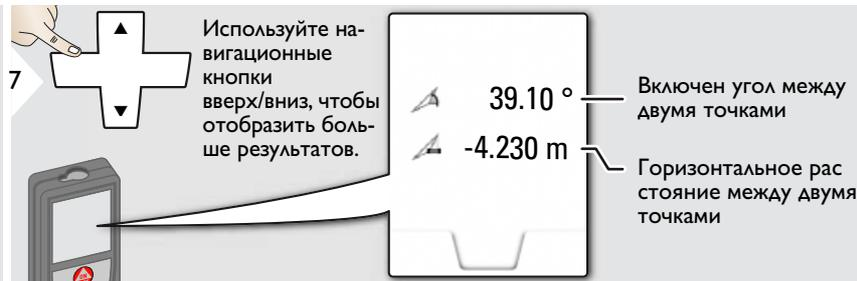
**1** Косвенное измерение расстояния между 2 точками с дополнительными результатами. Идеально подходит для измерения длины или наклона крыши, высоты купола на крыше, ...
