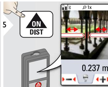
Выбрать стрелки с помощью курсорных клавиш, или нажав на сенсорный экран, и выберите нужные значения с помощью сенсорных клавиш. Рассчитан соответствующий диаметр.
