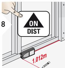
Медленно перемещайте прибор вдоль линии разметки. На дисплее отобразится расстояние до следующей точки разметки.
