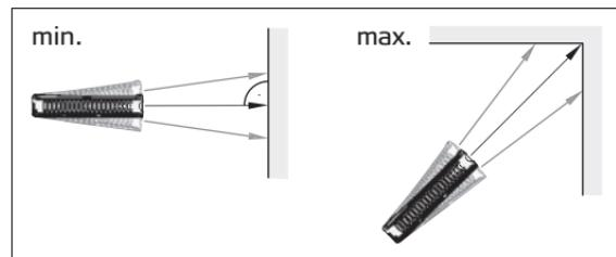
Чаще всего эта функция используется для измерения диагоналей (максимальные значения) или горизонтальных расстояний до вертикальной поверхности (минимальное значение).
