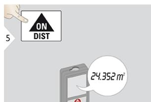
измерения. Измерьте, после чего выполните сложение или вычитание длин стен. Теперь измерьте высоту второй длины для получения площади стены.
