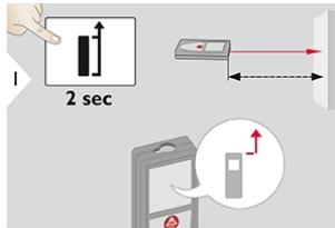
Расстояние измеряется от передней поверхности прибора.
