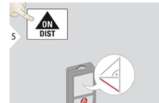
активирует автоматическое выполнение измерений минимального и максимального расстояния.
