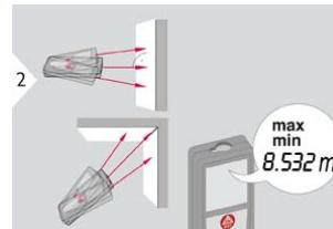
Эта функция используется для измерения диагоналей (максимальные значения) или горизонтальных расстояний до вертикальной поверхности (минимальное значение). Измеренное минимальное и максимальное
