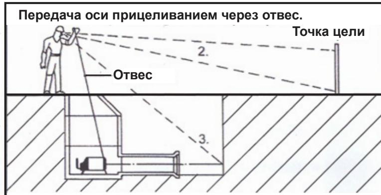
1. Установить лазер выше оси. 2. Посмотреть через отвес и выровнять его по вехе. 3. Посмотреть через отвес на лазерный луч и отрегулировать его по направлению.
