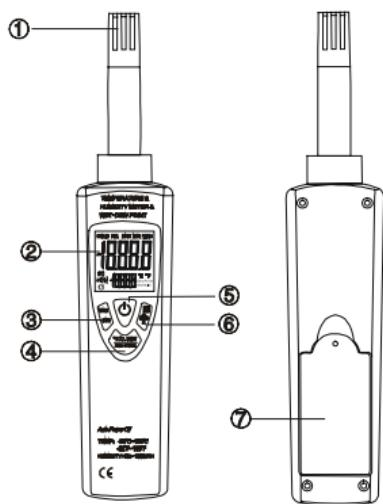
1. Зонд влажности/температуры воздуха: внутри находится полупроводниковый датчик влажности и температуры.
