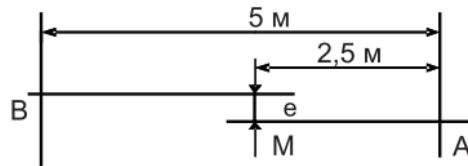
**Проверка точности вертикального луча**
