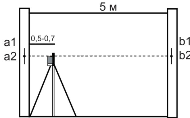
**Проверка точности горизонтального луча (изгиб плоскости)**
