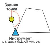
2. Для съемки хода не нужна предварительная установка пикета, так как эта процедура входит в функцию. При начале съемки хода вам будет предложено ввести обычные параметры окружающей среды (температура окружающей среды, атмосферное давление, преломление и возможное использование кривизны земли), как вы действовали бы в ходе стандартной процедуры установки пикета в известной точке.
