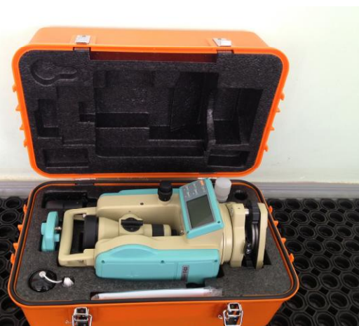
Рисунок 4 - Внешний вид теодолита при размещении в футляре
