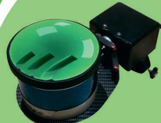
В основе данной системы используется LiDAR Velodyne Puck Lite и модуль обработки информации, разработанный с учётом современных требований к скорости и точности обработки данных.
