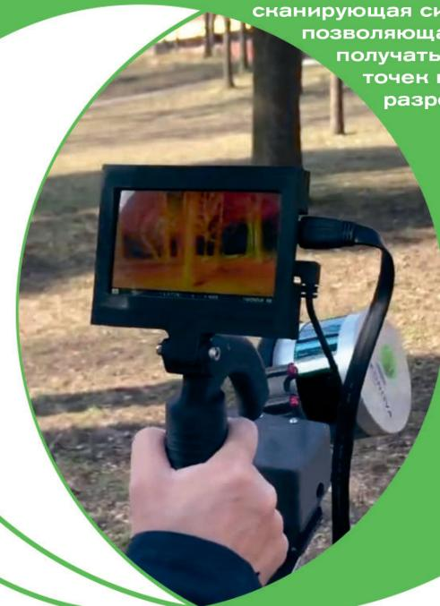
Система **BATHANDHELD** используется при решении большого количества задач, связанных с картографированием и сбором 3D данных местности. Можно выделить несколько основных направлений:
