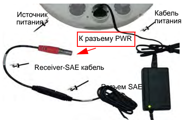
Рисунок 20. Подключение питания к приемнику ТРИУМФ-1
