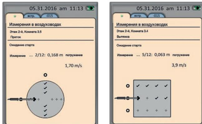
После того, как измерения закончены, прибор вычисляет общую погрешность в соответствии со стандартом EN 12599
