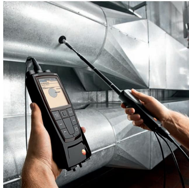
Затем testo 480 поможет Вам провести все измерения на воздуховодах шаг за шагом с помощью:
