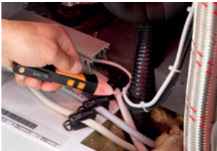
Первый тест подачи напряжения на компрессоре
