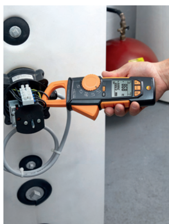
Измерение напряжения на бойлере с testo 770.
