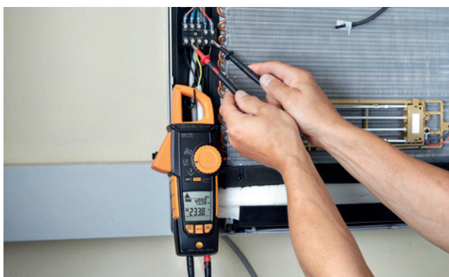
Измерение напряжения на блоке кондиционера с testo 770.
