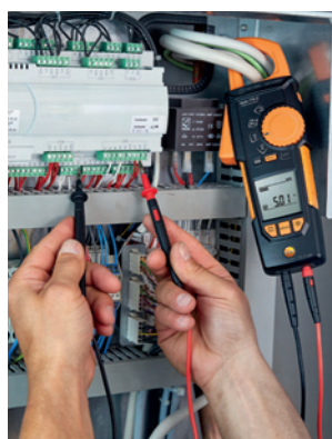
Измерение напряжения в распределительном щитке теплового насоса путем подвешивания прибора.
