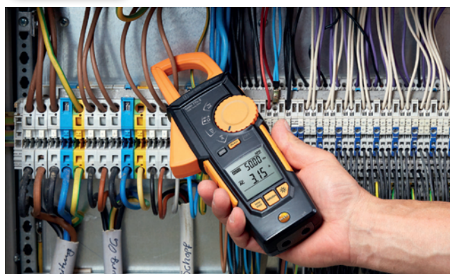
Измерение силы тока в распределительном щитке.
